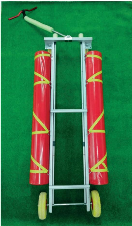
El elemento de flotabilidad está fijado a los laterales, fabricado con espuma de polietileno reticulado, FOAM LEISIS garantizado con EVA FLG-E, son flotadores flexibles y suaves al tacto, con capacidad de recuperación y resistencia a la rotura.
